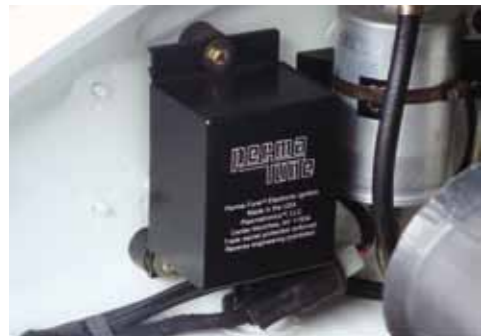
Importware: Zündbox des auch bei uns distribuierten US-Herstellers Perma-Tune
