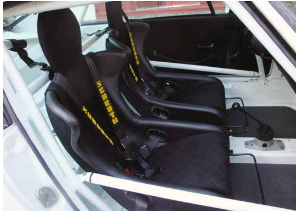
Demontierbarer Flankenschutz: Heigo-Überrollkäfig mit geschraubten Gabelköpfen
