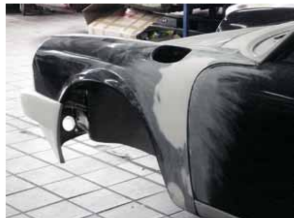
Kunststoffbau: vordere, leicht ausgestellte Kotflügel und beide Türen aus Glasfaser-Material
