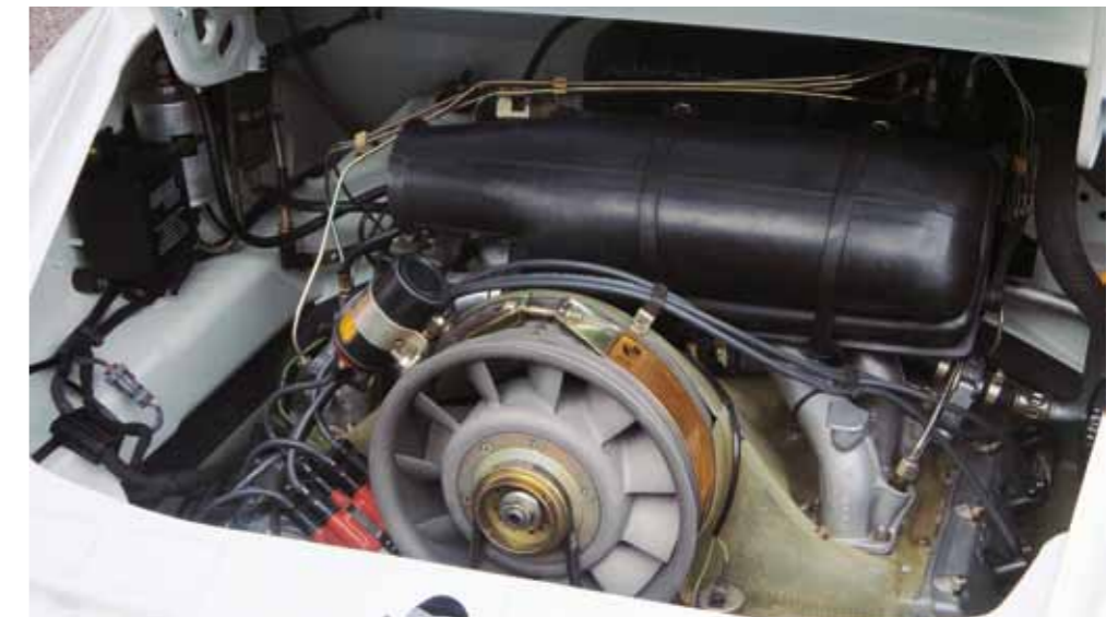
Reminiszenz an Rennlegenden: Motorverblechung aus bernsteinfarbener Glasfaser
