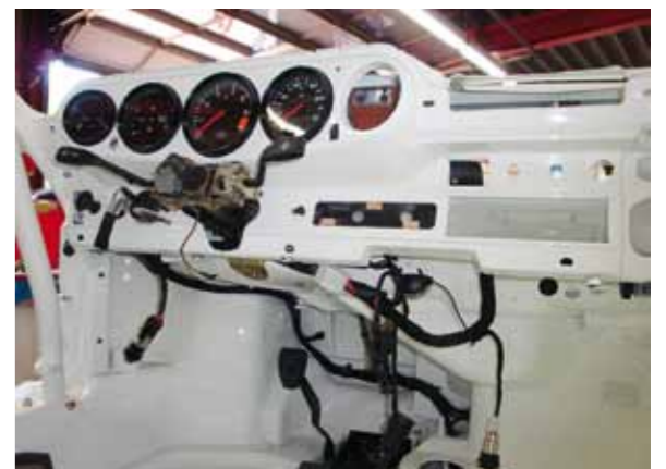
Oh Kabelbaum, oh Kabelbaum! Jedes überflüssige Gramm Gewicht herausgeschnitten
