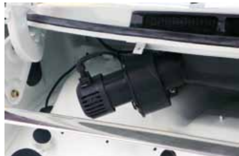
Minimalistische Belüftung der Frontscheibe: Nur ein kleiner Elektromotor macht Wind
