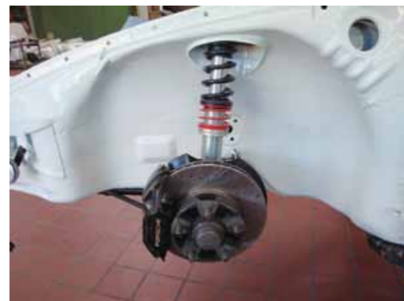
An der Vorderachse aus Stahl: Bilstein-McPherson-Federbein mit H&R-Schraubenfedern
