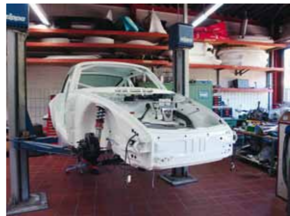
Anlieferung auf dem Rollwagen: Patrick Zimmermann erhielt eine vorgrundierte Karosserie
